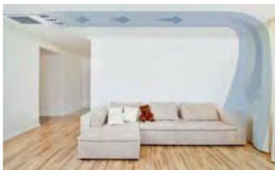
Подача потока воздуха с эффектом «коанда» («налипания воздуха»)
